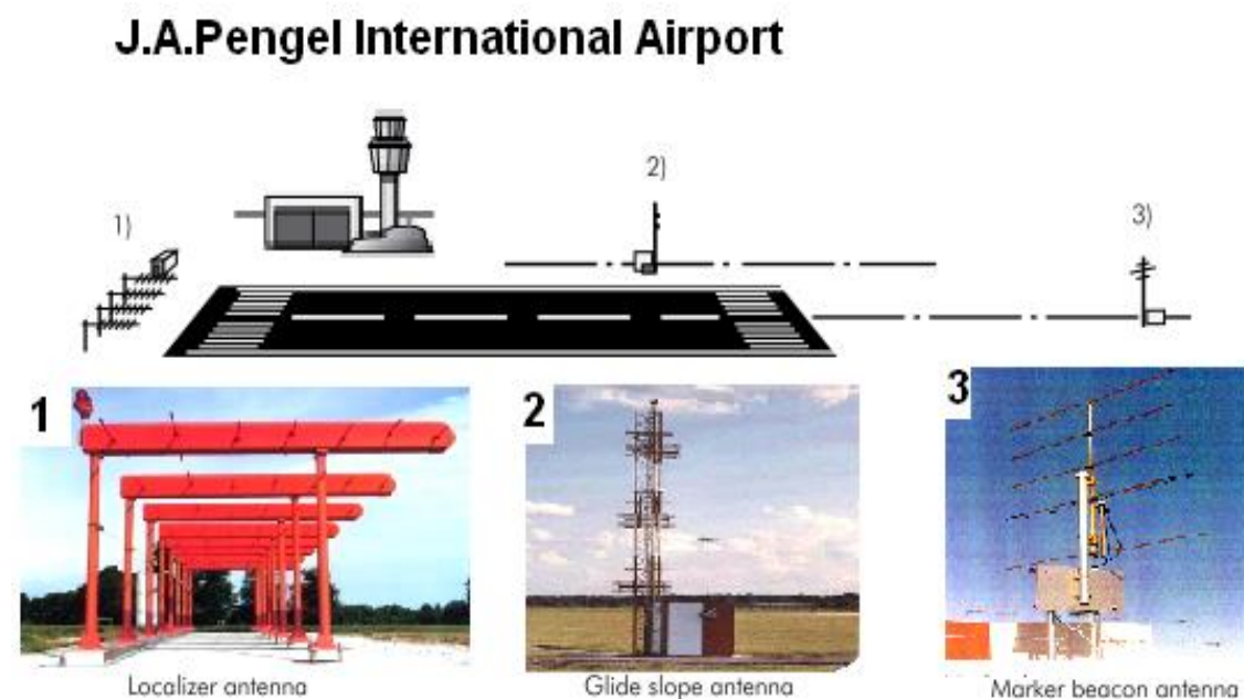
Figuur 9: Huidige situatie ILS - installatie van Zanderij
